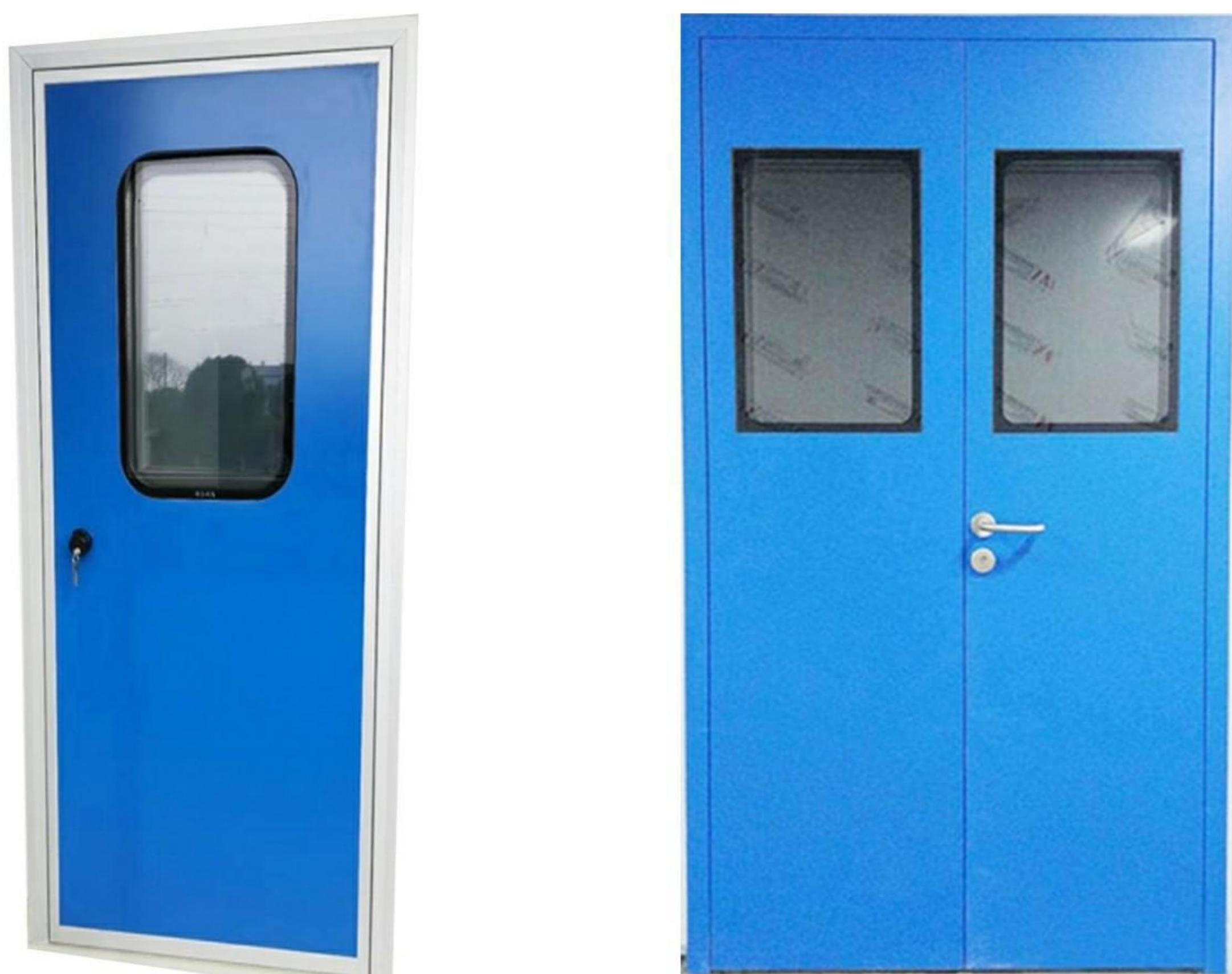
درب HPL اتاق تمیز از یک صفحه درب ساخته شده از ساندویچ پانل HPL و یک قاب آلومینیومی تشکیل شده است. از آنجا که صفحه HPL دارای ویژگی های مقاومت در برابر خوردگی ، مقاومت در برابر ضربه ، مقاومت در برابر درجه حرارت بالا و مقاومت در برابر درجه حرارت پایین است ، عمدها در کارخانه های صنایع دارویی و کارخانه های صنایع شیمیایی مورد استفاده قرار می گیرد.
